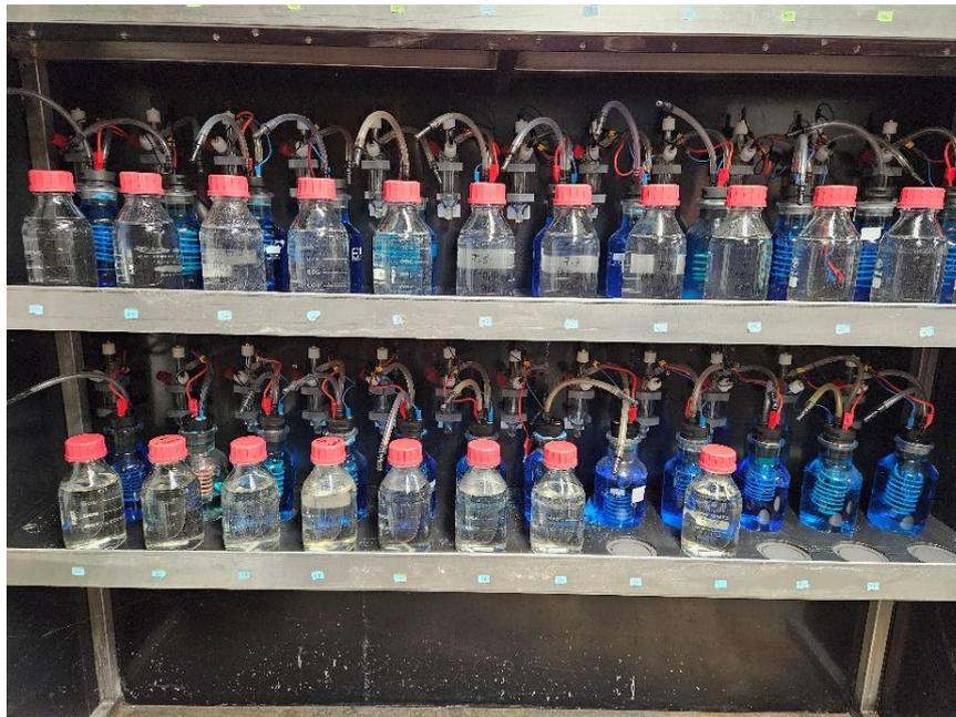
Abbildung 33: Versuchsaufbau der Rührversuche mit Pulveraktivkohle
