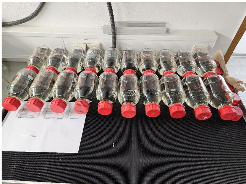
Abbildung 36: Schüttelversuch mit granulierter Aktivkohle
